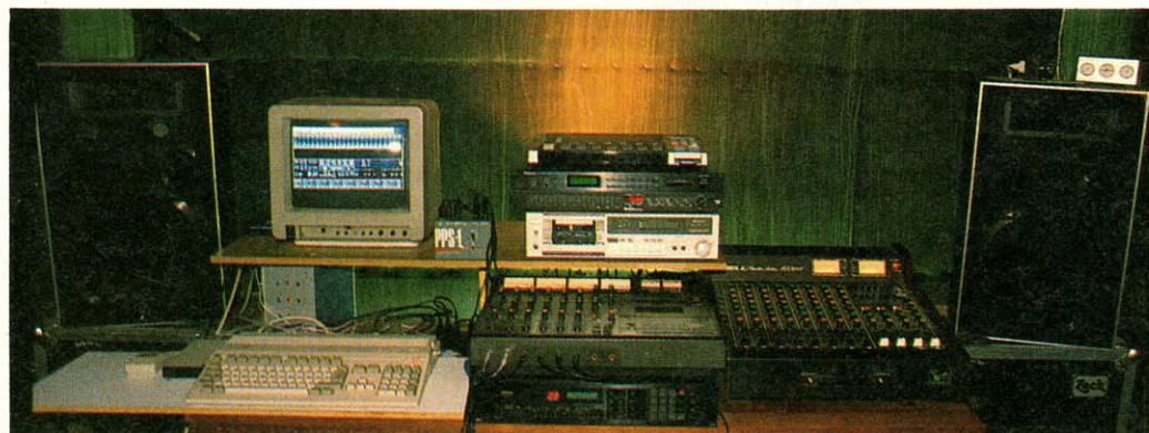
MIDI-Studio mit Amiga, Expansoren, Mischer und Boxen: Wände und Decke schalldämmend.
