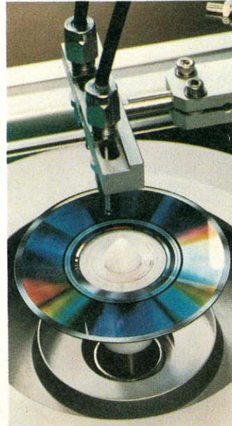
UV-härtbare Lacke werden im Rotationsverfahren aufgeschleudert.
