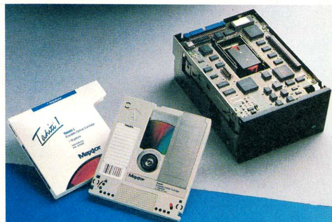
Das Tahiti-Laufwerk (wiederbeschreibbar, 650 MByte) mit einer mittleren Zugriffszeit von 30 ms läßt sich mit einem SCSI-Controller (Impact 2000) am Amiga anschließen
