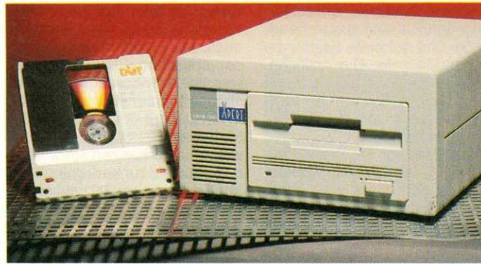
Das Tahiti-Laufwerk von Maxtor (mittlere Zugriffszeit 35 ms) wird mit dem Impact-SCSI-Controller am Amiga betrieben. Das Laufwerk kann auch in einen Tower eingebaut werden.
